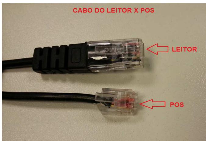
Utilizando o cabo de comunicação que também alimenta a leitora, conecte a leitora com a o POS através da conexão RS232 do POS, aguarde o led verde da leitora parar de piscar.
